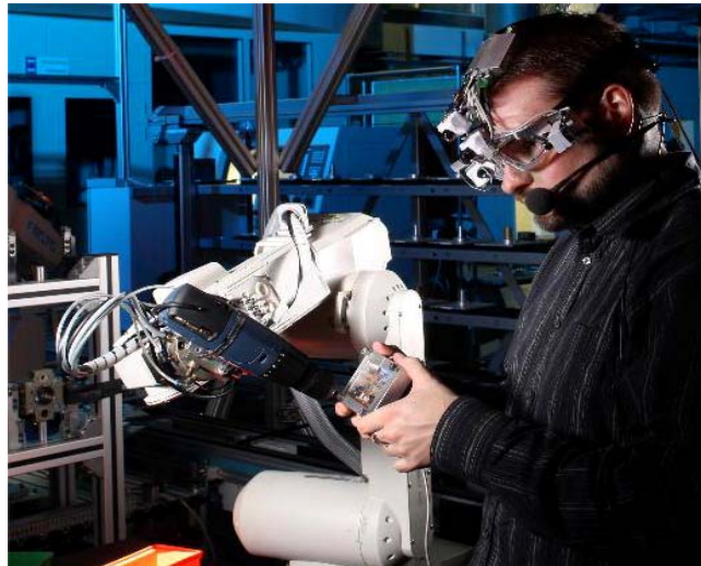
Die Zukunft der industriellen Produktion ist in der CoTeSys-Modellfabrik bereits Realität: Mensch und Roboter arbeiten Hand in Hand. Der Roboter erkennt, wann und wo er den Elektroschrauber ansetzen muss. (Foto: CoTeSys/Kurt Fuchs)
